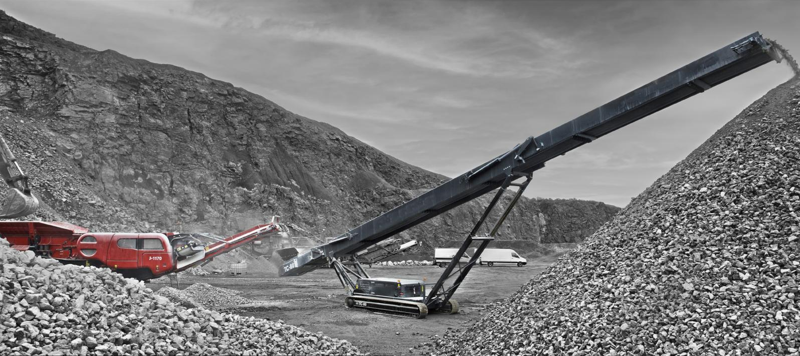
El apilador móvil Finlay® TC-80 es una máquina altamente móvil y flexible que ofrece a los operadores una solución de apilado eficiente, fiable y rentable. Esta robusta máquina ha sido diseñada para ofrecer flexibilidad en una amplia gama de aplicaciones e incluye velocidad de banda variable, altura de alimentación ajustable y altura de descarga variable.
