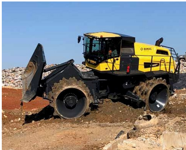
La plataforma de servicio da acceso a la zona de mantenimiento.
