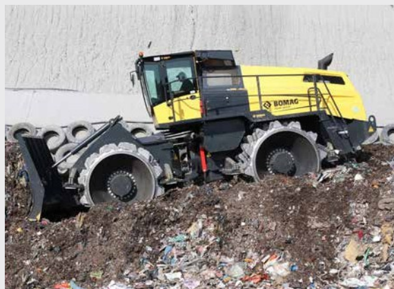
Compactación óptima con la articulación oscilante, que proporciona una buena distribución de la carga a las ruedas de compactación.
