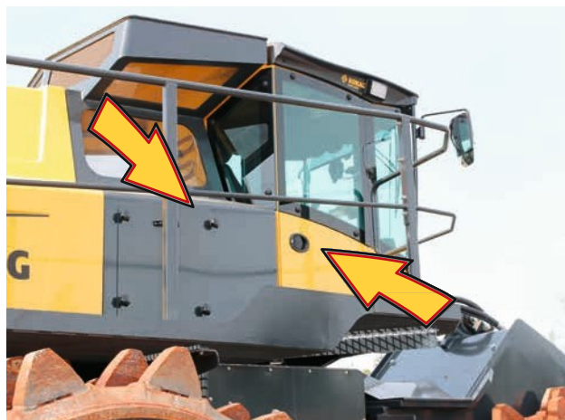
Acceso al radiador y apertura de mantenimiento para la unidad de aire acondicionado.
