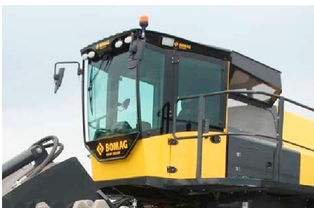
Cabina ROPS/FOPS con cristal de seguridad integral.
