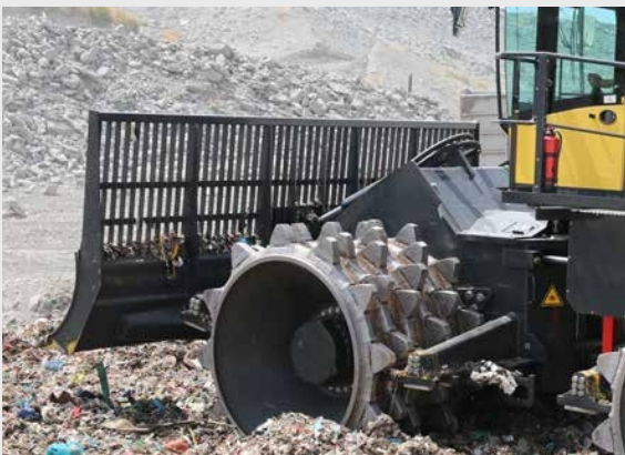
Los rascadores garantizan ruedas limpias y una alta compactación.
