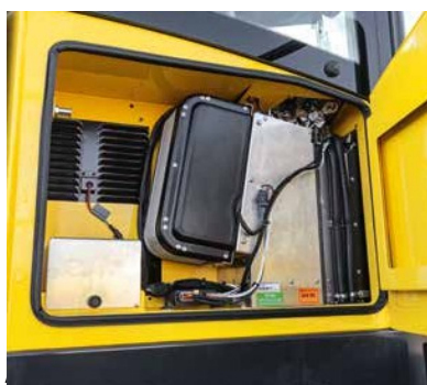
Acceso al radiador y apertura de mantenimiento para la unidad de aire acondicionado.
