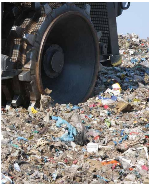
Los rascadores garantizan ruedas limpias y una alta compactación.
