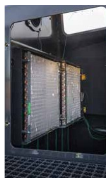
Acceso al radiador y apertura de mantenimiento para la unidad de aire acondicionado.
