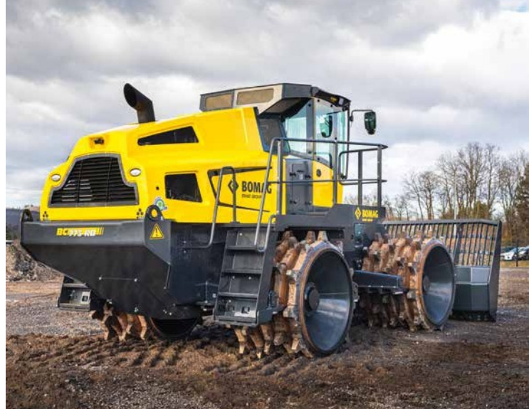
La plataforma de servicio da acceso a la zona de mantenimiento.
