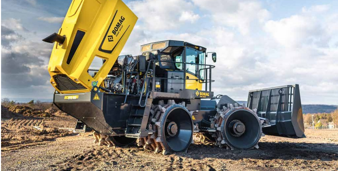
Acceso directo al motor, accesible por todas partes.
