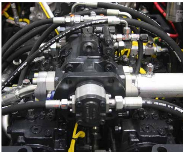
Accionamiento hidráulico de la bomba cuádruple con control de límite de carga para obtener el mejor rendimiento.
