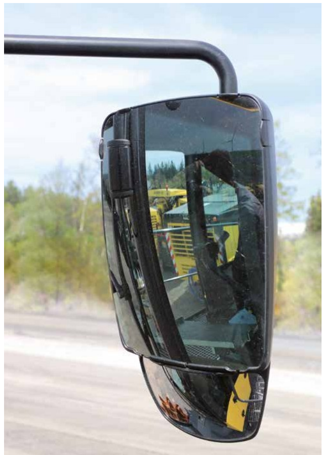
Ajuste óptimo de los retrovisores gracias a la regulación eléctrica.
