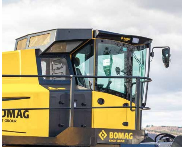
Cabina ROPS/FOPS con cristal de seguridad integral.
