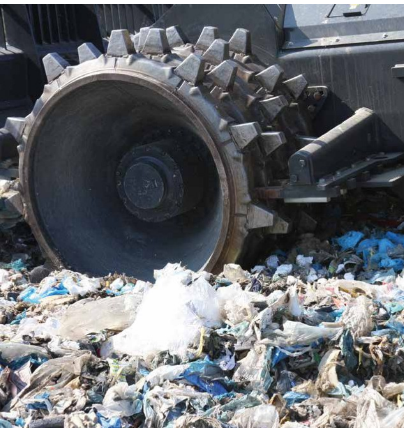
Ruedas BOMAG con dientes de primera calidad.
