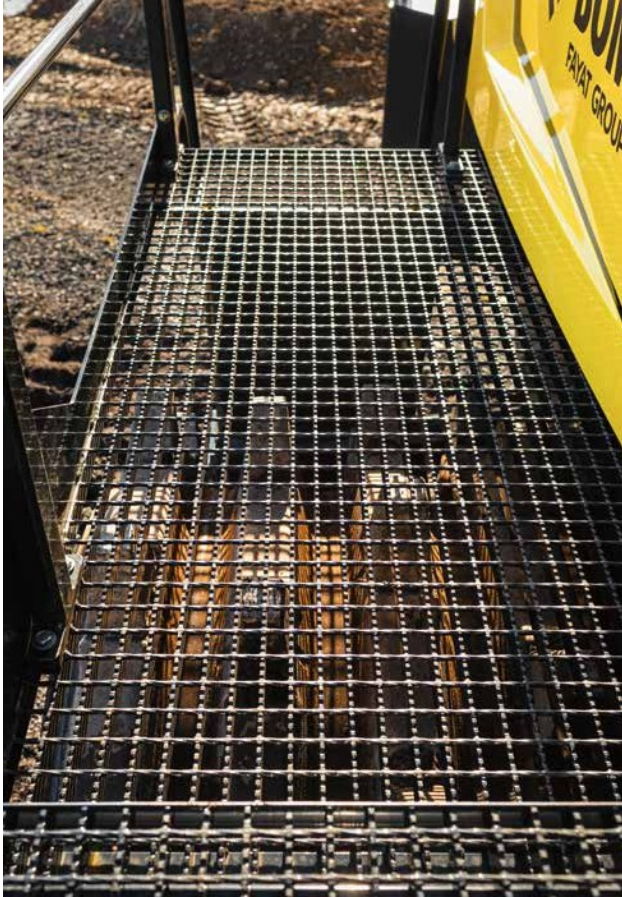
Las escaleras abiertas y la estructura de la plataforma mantienen las cosas limpias.
