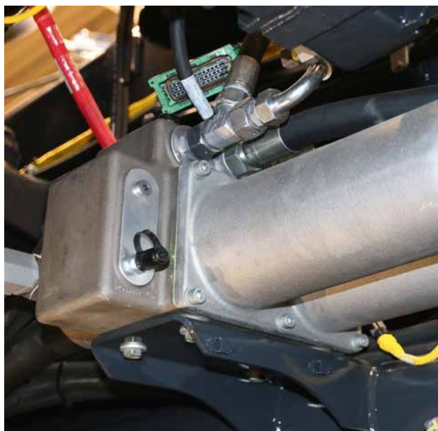
Control electrónico del filtro de retorno hidráulico.
