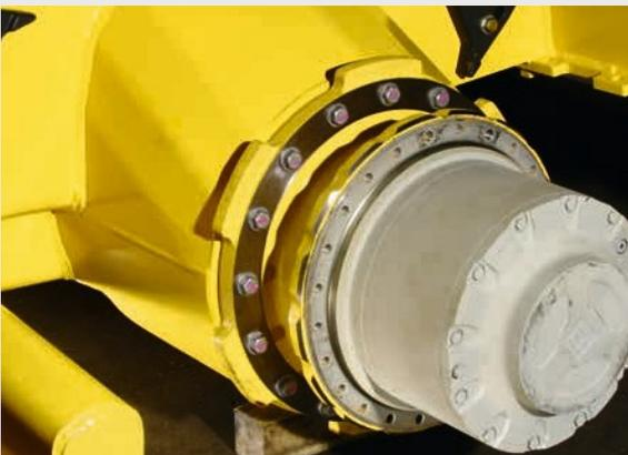
Dos sistemas de frenado independientes (hidrostático para el freno de servicio y de discos múltiples para el freno de estacionamiento).
