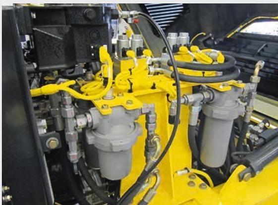
Lado de descarga del sistema de filtrado hidráulico.
