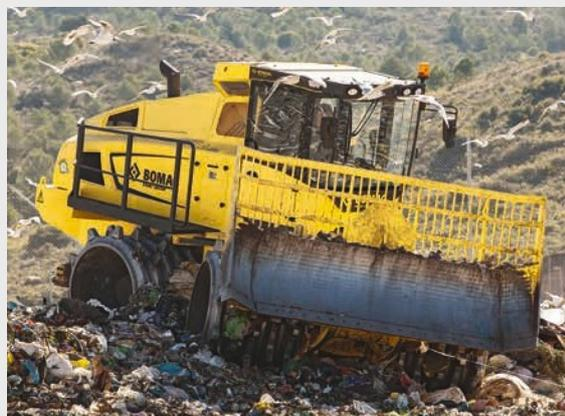
Compactación óptima con la junta oscilante, que proporciona una buena distribución de la carga a las ruedas de compactación.
