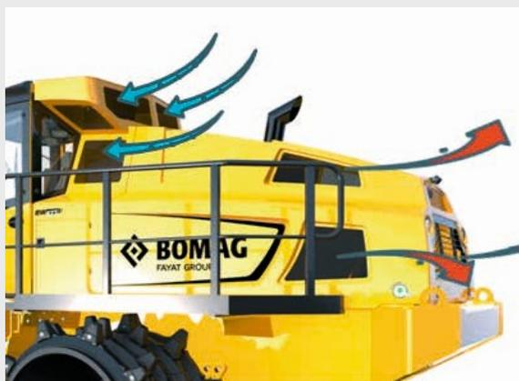
Aspiración de alto nivel para aire de refrigeración y combustión con niveles mínimos de polvo.
