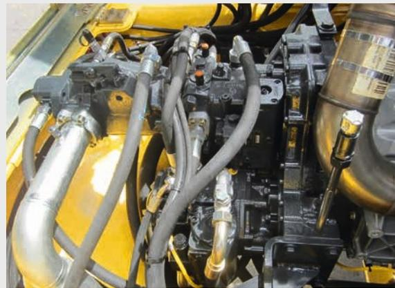
Accionamiento hidráulico de las ruedas con "control de límite de carga" (control de velocidad en función de la carga) (BC 473).
