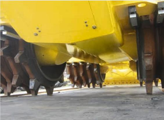
Bastidor con secciones cerradas para la mejor protección posible de todos los componentes y sin entrada de material; sin peligro de ignición en componentes calientes.
