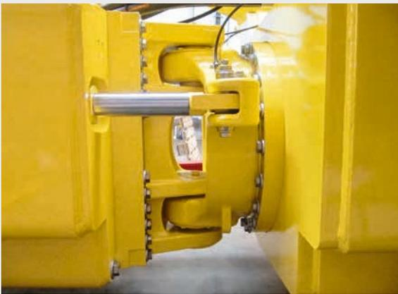
Alta tracción con la articulación oscilante (contacto continuo con el suelo).
