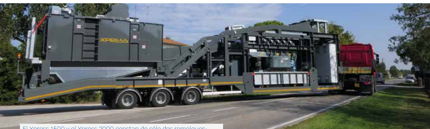
El Xpress 1500 y el Xpress 2000 constan de sólo dos remolques: 1 - Torre de mezcla; 2- Secador + filtro + 4 Predosificadores
