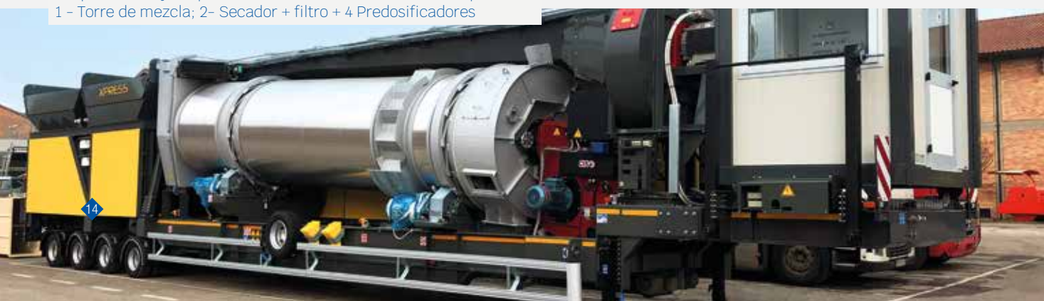
El Xpress 1500 y el Xpress 2000 constan de sólo dos remolques: 1 - Torre de mezcla; 2- Secador + filtro + 4 Predosificadores
