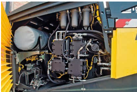
Ahorro de hasta el 17 % de combustible – Sistema hidráulico regulado por demanda – el ECOMODE de BOMAG.
