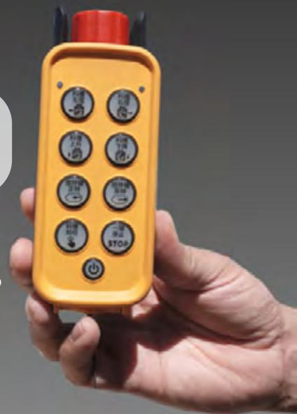
Controles de dirección y velocidad de giro de la olla en parte posterior de ambos lados.
